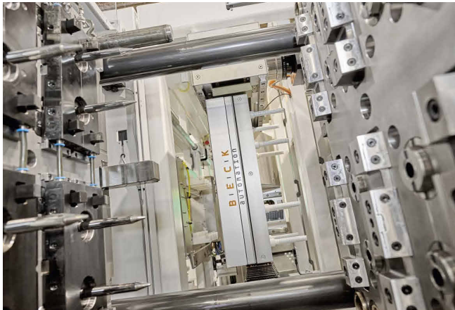
Bild 3. Das Handlingsystem fährt in das Werkzeug (links), um die Labels in den acht Kavitäten zu platzieren. Dabei ist höchste Präzision gefragt, damit die Skala in der Anwendung ihren Zweck verlässlich erfüllt. © Arburg
