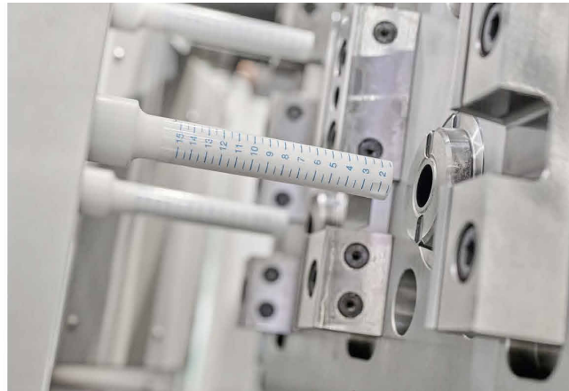
Bild 3. Das Handlingsystem fährt in das Werkzeug (links), um die Labels in den acht Kavitäten zu platzieren. Dabei ist höchste Präzision gefragt, damit die Skala in der Anwendung ihren Zweck verlässlich erfüllt. © Arburg
