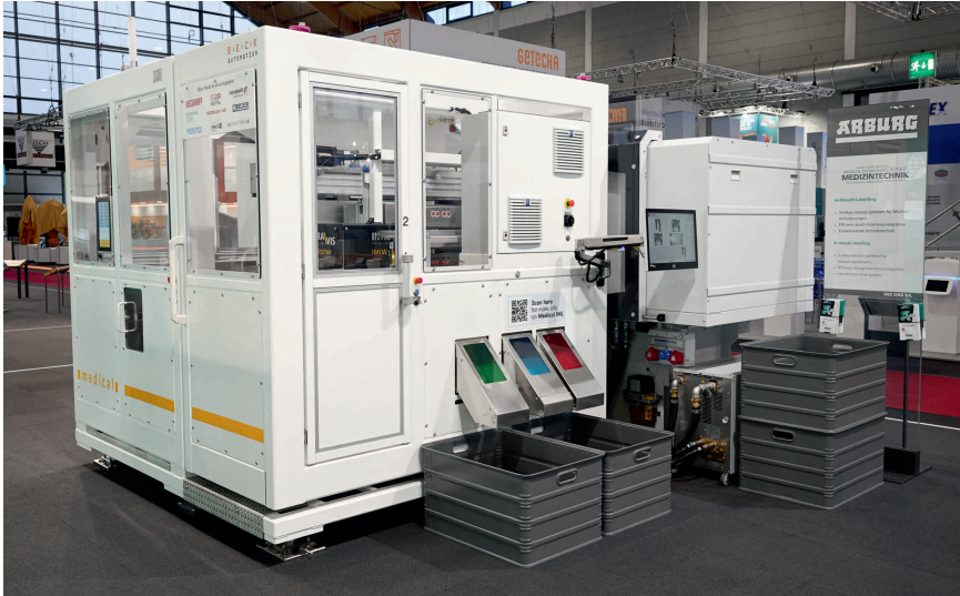
Bild 5. Die kompakte Fertigungszelle arbeitet kosteneffizient mit hohem Ausstoß und geringer Ausschussrate – und ohne zusätzliches Hygienierisiko. © Arburg
