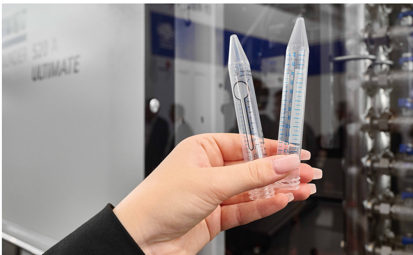
Dank funktionaler IML-Label erhalten die Zentrifugenröhrchen zum Beispiel eine Füllskala und temperatursensitive Elemente. Letztere zeigen per Farbumschlag an, wenn die Kühlkette unterbrochen wurde. © Arburg
